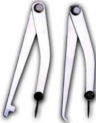
شكل رقم ٦٠: الفرجار احادي الرجل Odd-Leg calipers
