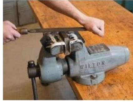
شكل رقم ١١٧: الطريقة الصحيحة للإمساك بالمبرد أثناء عمل برادة للأسطح.
