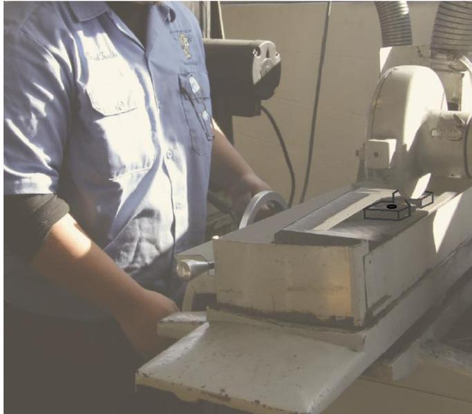
شكل رقم ٢٤٤: ملامسة حجر الجليخ و ضبط عمق التغذية
