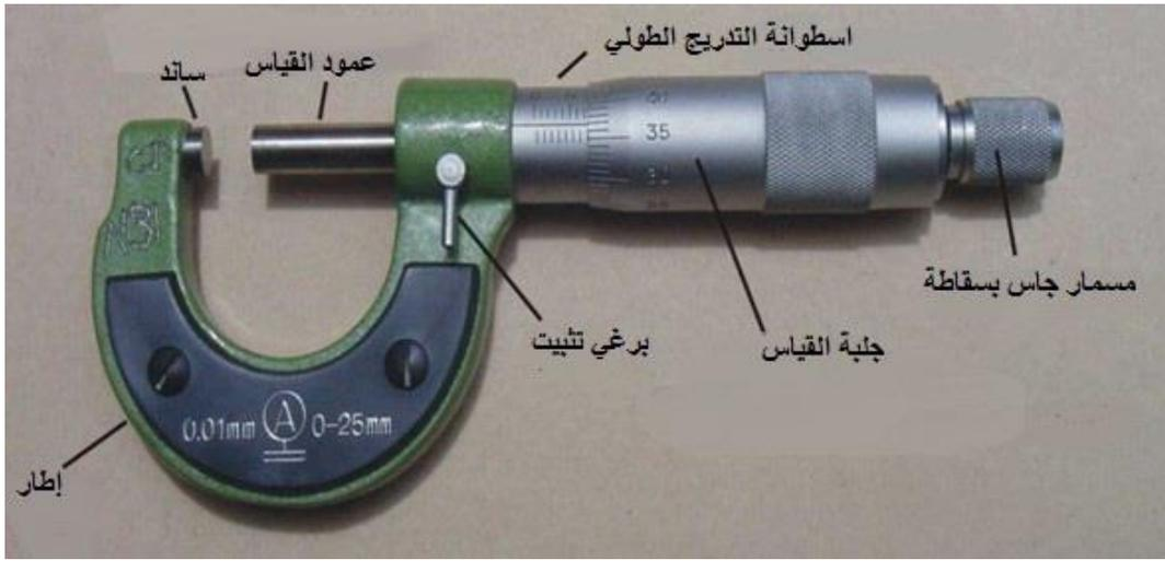
شكل رقم ٦٥: المكونات الرئيسية للميكرومتر.
